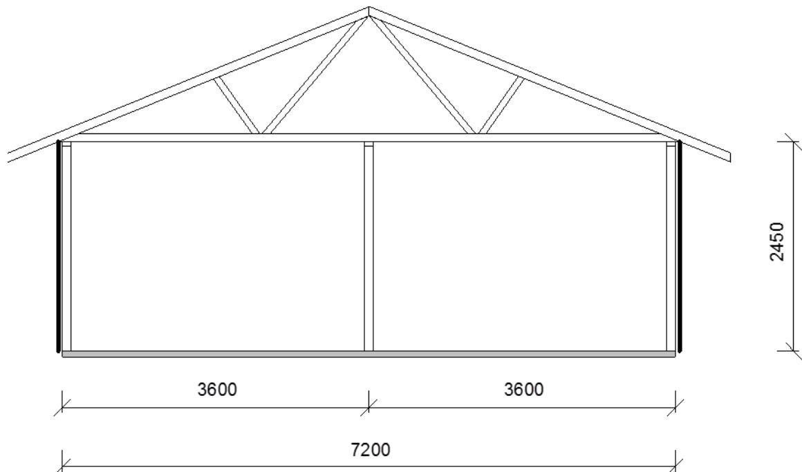
Jobben består i å bygge en ny takkonstruksjon med saltak og oppholdsrom på loftet, etterisolere ytterveggene med 100 mm mineralull og skifte utvendig kledning. Innvendige overflater i 1. etasje skal ikke berøres.
