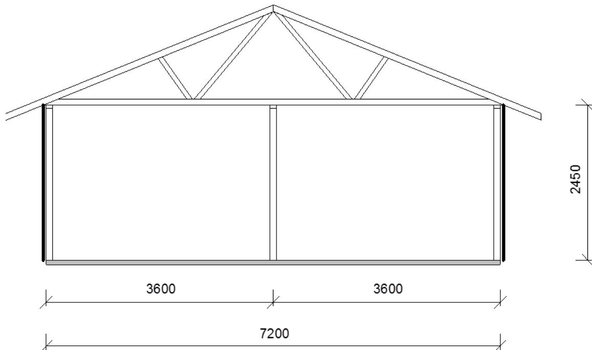
Jobben består i å bygge ein ny takkonstruksjon med saltak og oppholdsrom på loftet, etterisolere ytterveggene med 100 mm mineralull og skifte utvendig kledning. Innvendige overflater i 1. etasje skal ikkje rørast.
